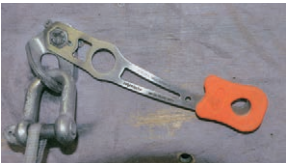
ナッツバスターによるボルト締め
