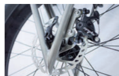
【機械式ディスクブレーキ】ブレーキアクチュエーターはリッターのフレームに取り付けます。
