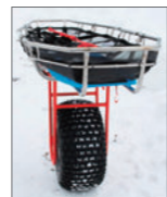
フレームにはパウダー塗装処理をし雪等の付着に配慮しています。
